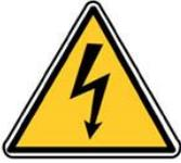
La dimension du côté doit au moins être égale à 100 mm.
